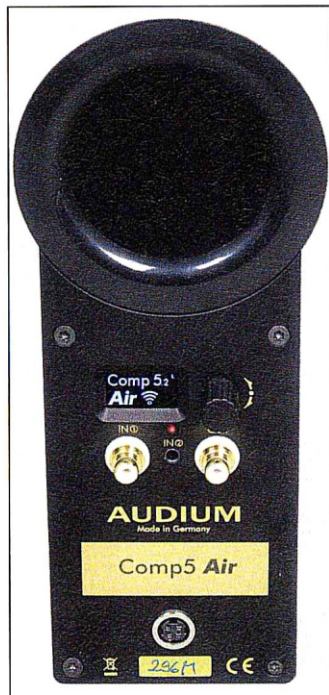
Das Anschlussfeld ist eher spärlich ausgestattet. Alle Einstellungen lassen sich über das kleine Display und den Drehknopf vornehmen.
