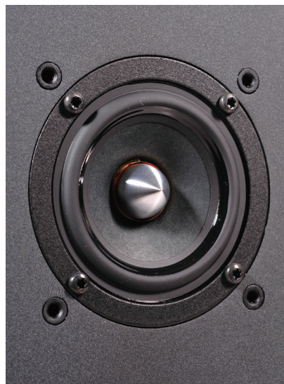
厂方自行研发的3吋(75mm)全频单元,采用金属子弹头相位锥,音质之出色令人惊讶
