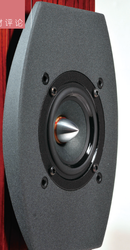
厂方自行研发的3吋(75mm)全频单元,采用金属子弹头相位锥,音质之出色令人惊讶。悬浮的前障板背部采用弧形设计,可改善影响音质的绕射效应
