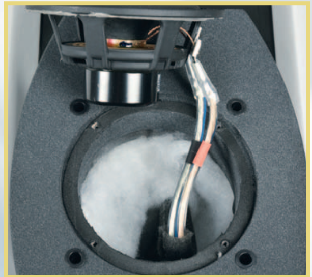
Der Papp-Breitbänder (oben) mit Neodym-Magnet spielt auf ein kleines, gut bedämpftes Volumen.
