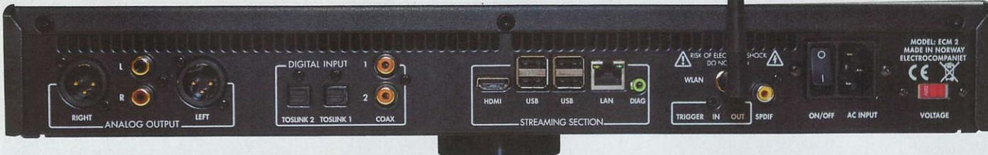
Hinter der „Streaming-Section“ liegt das Computerboard des ECM2. Das kann zusätzlich zum internen Speicher bis zu vier externe USB-Laufwerke verwalten. Ganz links erkennen Sie die analoge Ausgangsplatine mit ihren symmetrischen XLR-Anschlüssen und dem Cinch-Duo.
