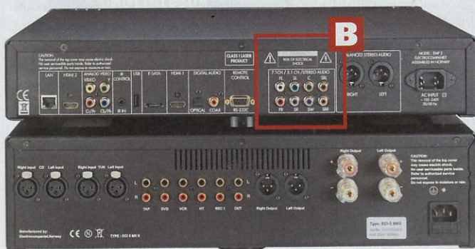
Anschlüsse satt: ECI 5 (unten) und EMP 2 (oben) sind symmetrisch ausgelegt. Das bunte Multichannel-Oktett am Player (B) sollte man allerdings meiden
