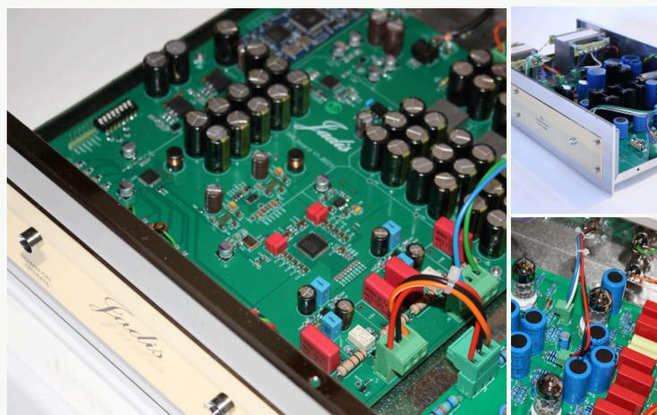
Un étage d'amplification suivi d'un étage adaptateur d'impédance assurent la qualité musicale du signal de sortie alimentant de façon optimale le maillon suivant.
